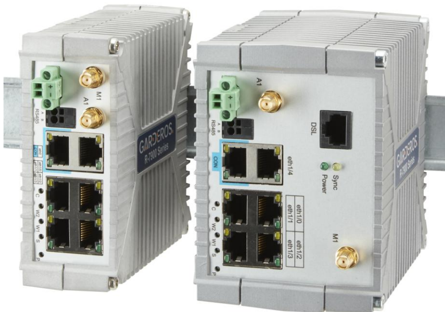
Abbildung 1: Garderos R-7900 Multifunktionsrouter für Smart-Grid-Anwendungen.
