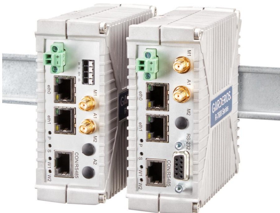
Abbildung 1: Garderos R-7600 Router mit Single Radio optimiert für Smart-Grid.
